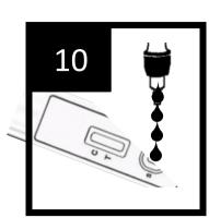
Testkassette aus dem Folienbeutel nehmen und auf eine flache, saubere Fläche legen. 4 Tropfen der Probenlösung auf die Probenvertiefung (S) der Testkassette auftragen.
