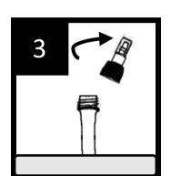
Pufferröhrchen in den Röhrchenhalter stecken und Schraubverschluss abnehmen bzw. Schutzfolie abziehen.
